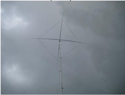
Photo : F6BKD Dipôle replié 14MHz @ 15m
